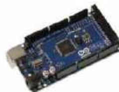
Gambar 1. Mikrokontroler Arduino Mega
