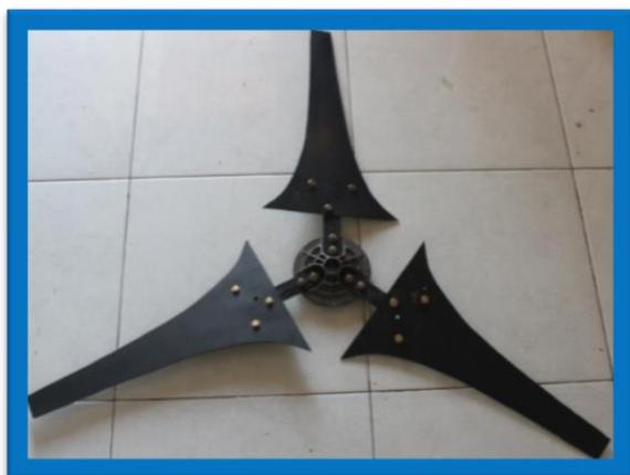
Gambar 8. Turbin Angin Material Arkrilik Setelah Selesai Dirancang, Dibuat dan Dirakit
