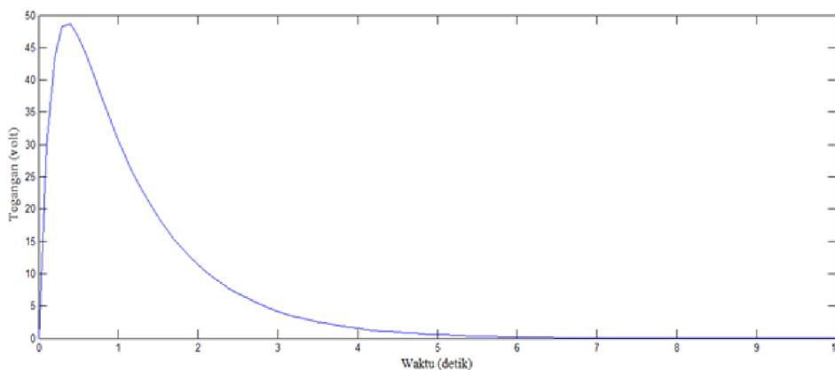
Gambar 1. Grafik tanggapan alami rangkaian RLC paralel
