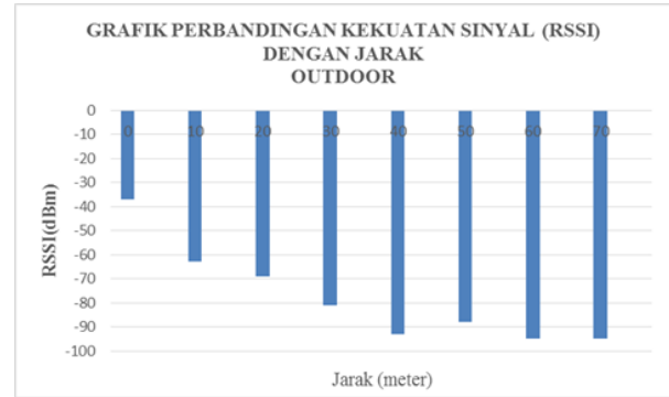
Grafik 3.4 Pengujian hubungan jarak terhadap kekuatan sinyal/RSSI (-dBm) diluar ruangan (Outdoor).
