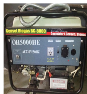
Gambar 3. Genset Dual (Biogas/Bensin)
