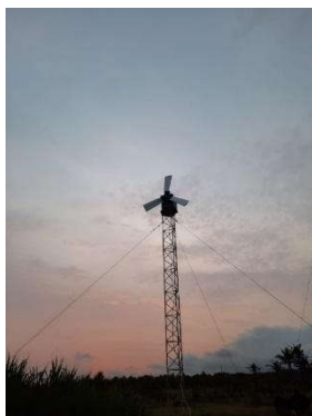
Gambar 15. Implementasi turbin angin AFPMG pada tiang 5 meter
